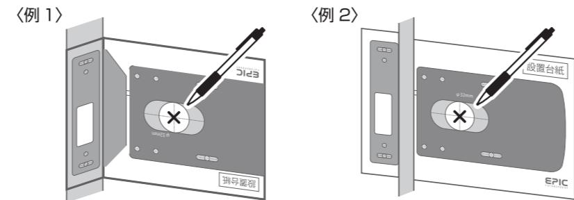
直径32mmの穴の中心に印を付けます。ネジ穴を開ける必要がある場合はネジ位置にも印を付けますが、後ほど位置を微調整する可能性があります。ネジ留めをする直前まで、穴を開けないようにしてください。
