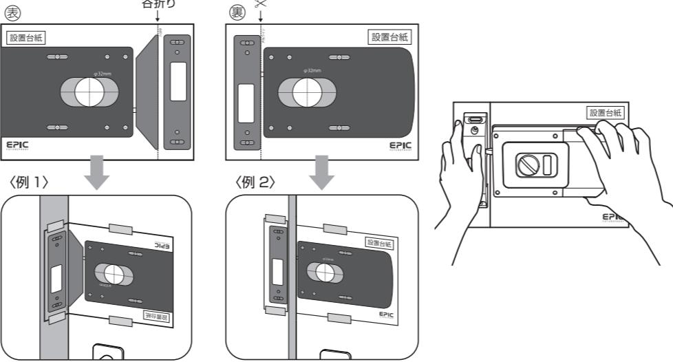
台紙を点線でカットし（ストライク部分と室内機部分を分離）マスキングテープで固定してください。ストライクと室内機を台紙に合わせて当てながらドアを開け閉めし、ストライクと室内機が干渉せず問題なく開閉できるか、デッドボルトを出し入れした際にストライクにきちんと収まるか等をチェックしてください。
